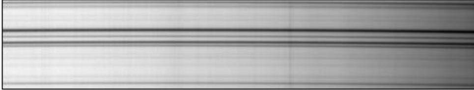
On reconnaît nos deux raies du fer, proches du centre. L'acquisition a ici été faite avec une caméra ASI462MM (pixels de 2,9 microns, binning 1x1).
